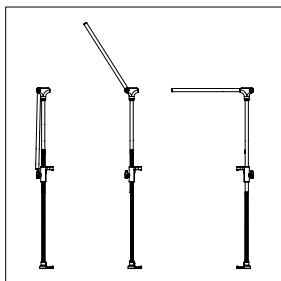
3. Klappen Sie nun den **Gelenkarm** ⑦ so um, dass dieser in waagerechten Position in der Halterung einrastet. Lösen Sie die **Kunststoffschraube** ④ und stellen Sie die voraussichtlich benötigte Höhe ein.
