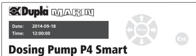
**Programmierung der Uhrzeit:** Durch Drücken der **Menu** Taste gelangen Sie in die Programmierenebene.
