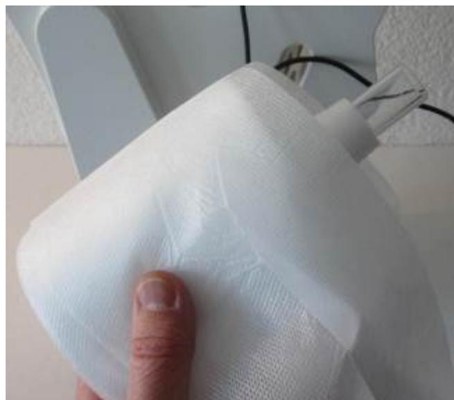
**Trennen Sie den Motor und das Aufwickelrohr und drücken Sie dann das Rohr auf einer Seite heraus.**
