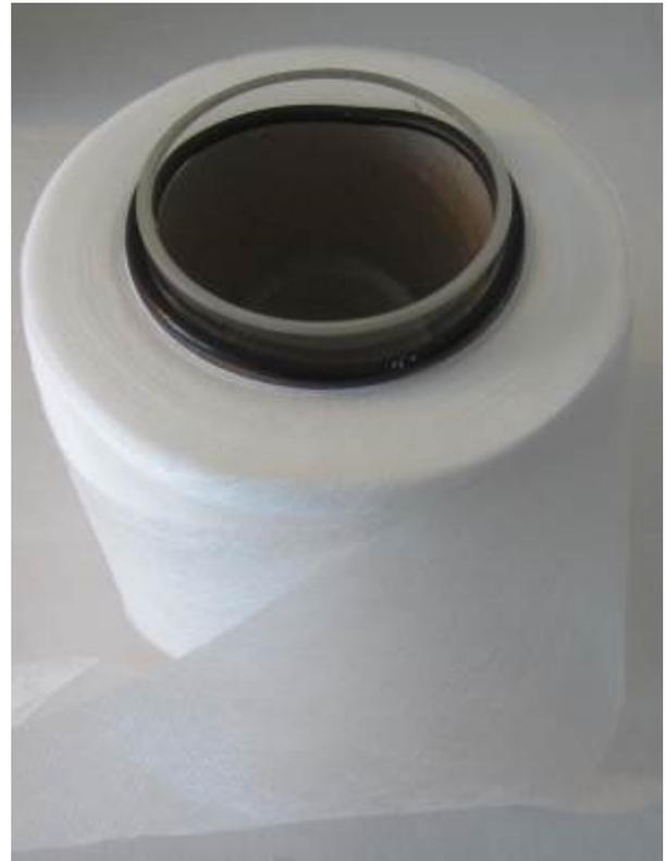
**Nehmen Sie eine neue Vliesrolle und befestigen Sie die Rolle mit O-Ringen am Schlauch**
