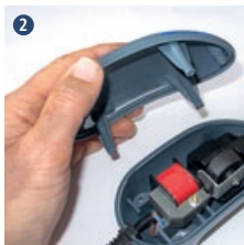
Retirez le couvercle de la pompe
