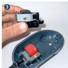
Aflojar la cámara de aire y retirarla de la carcasa
