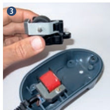
Desserrez les vis du réservoir d'air et sortez-le du boîtier
