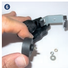
Membrane wird vom Magnetbügel gelöst
