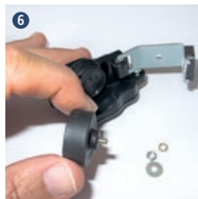
Separar la membrana de la pieza magnética
