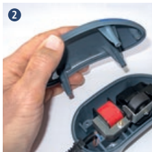
Het deksel van de pomp wordt verwijderd
