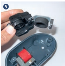
Membrane wird samt Magnetbügel am Gummilager nach außen gedrückt
