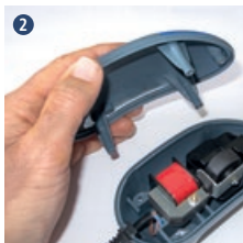
Rimozione del coperchio della pompa
