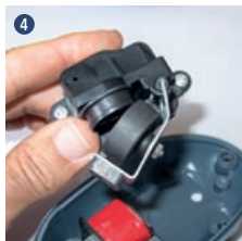
Rimozione della membrana dalla camera d'aria
