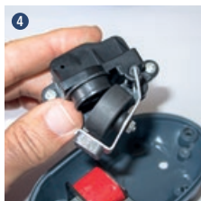
Sortez la membrane du réservoir d'air
