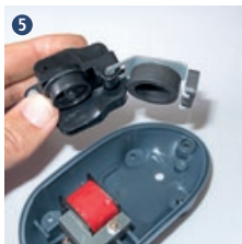
Presionar hacia afuera la membrana con la pieza magnética en el soporte de goma
