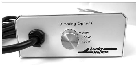
**Achtung:** Über den Schalter an der Stirnseite des Geräts kann die Wattage eingestellt werden. Achten Sie darauf, dass die Einstellung mit dem verwendeten Leuchtmittel übereinstimmt. Der Wechsel der Wattagen darf nur bei gezogenem Netzstecker erfolgen!
