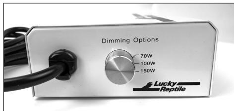
**Tenga en cuenta:** A través del interruptor que se encuentra en un lateral del aparato se puede ajustar la potencia. Asegúrese de que el ajuste coincida con el alumbrado utilizado. ¡Recuerde que el ajuste de potencia del balastro sólo se debe realizar con el balastro con el desconectado de la red eléctrica!
