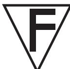
Leuchten, geeignet zur Montage auf normal entflammbaren Befestigungsfächen
